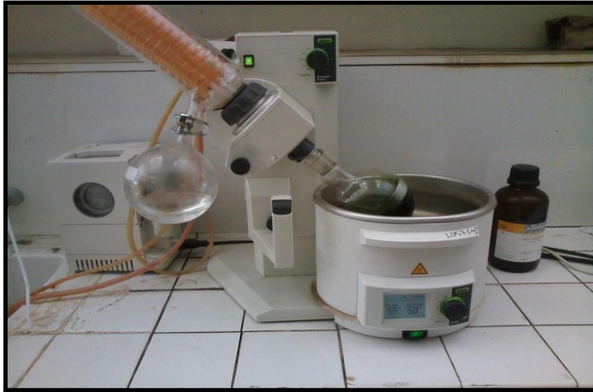
Figure 08 : Evaporateur rotatif de type BUCHI R-210
